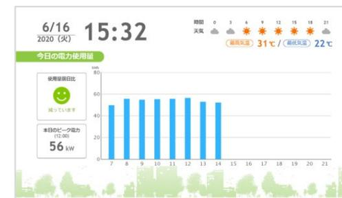
HEMS,BEMS : エネルギーマネジメントシステム。エネルギーの使用状況を見える化し、分析して削減に繋げるシステム
